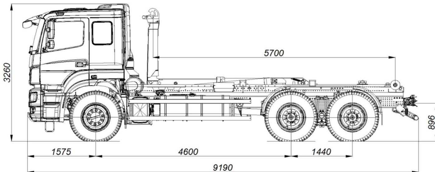
Размеры даны для автомобиля специального снаряженной массы: - с шинами 12.00R24
