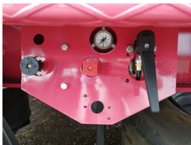
Краны управления пневмосистемой
