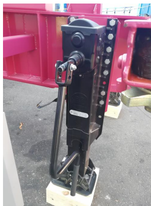
Опорные устройства BPW/FUWA в исполнении, не требующем значительного техобслуживания: - с односторонним управлением; - с шарнирной опорной пластиной; - с двухступенчатым редуктором
