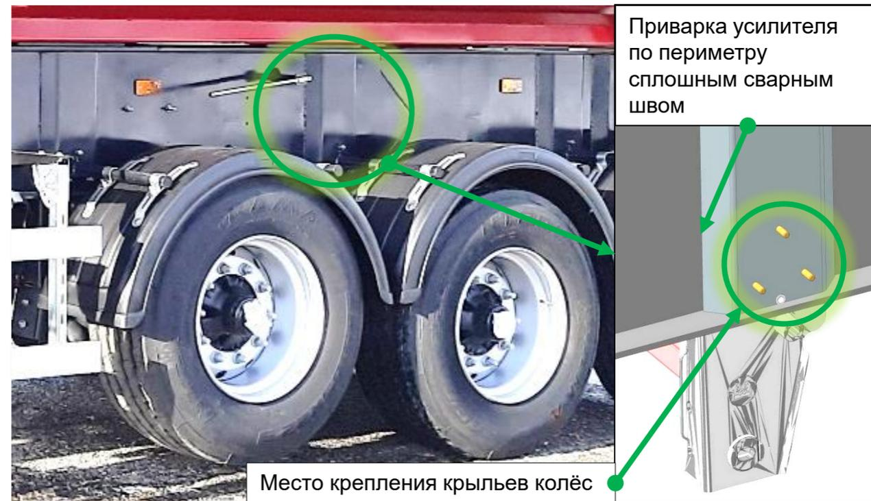
Модернизированная рама с усилителями лонжеронов коробчатого типа в местах установки кронштейнов подвески
