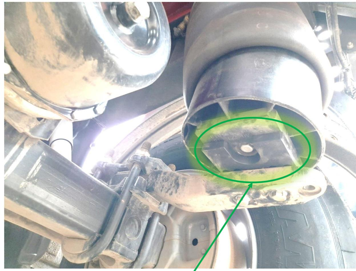
Для повышения надежности опоры пневмоподушки при критических нагрузках дополнительно введена усилительная пластина толщиной 16 мм между рессорой и пневмоподушкой
