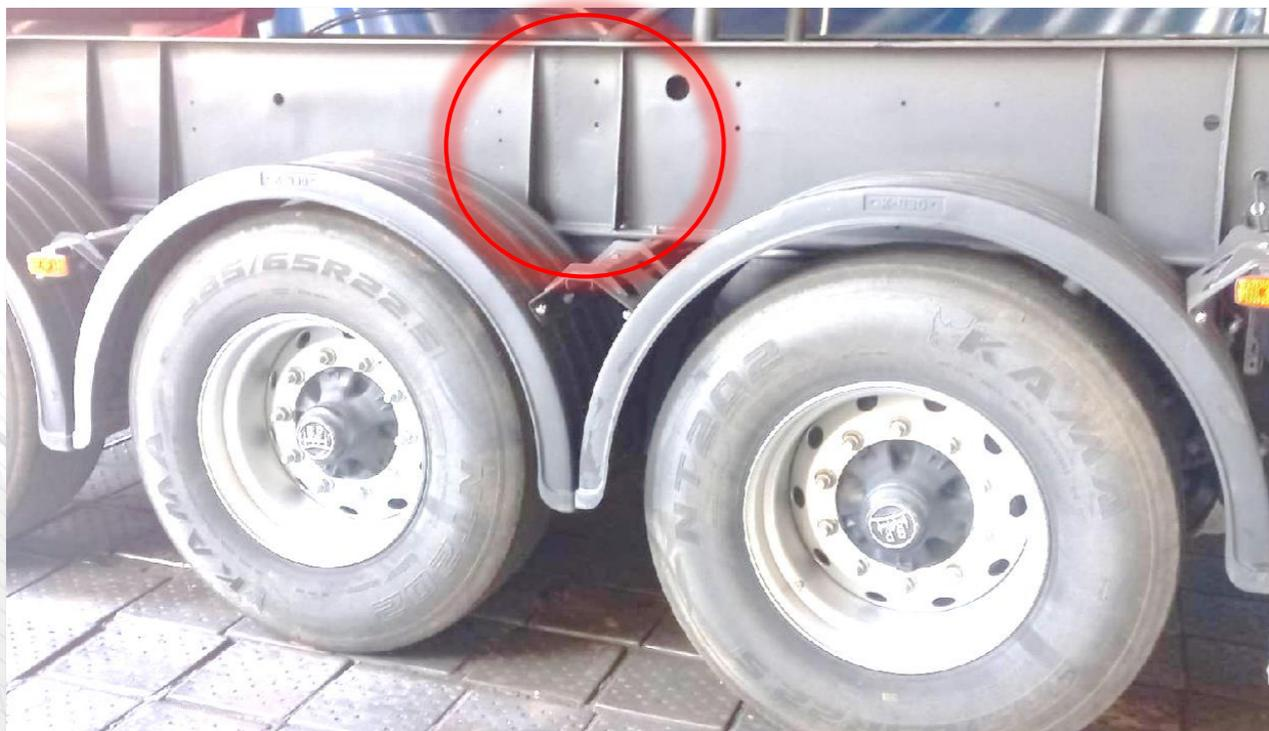
Рама с усилителями лонжеронов косынчатого типа в местах установки подвески
