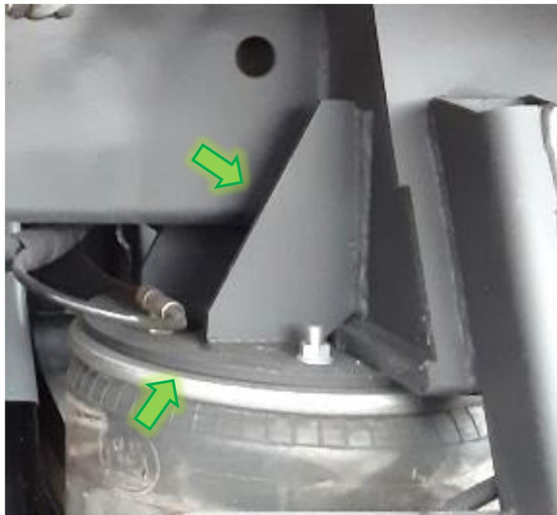
В конструкцию подвески введена усилительная пластина и кронштейны для исключения разрушения пневмоподушки
