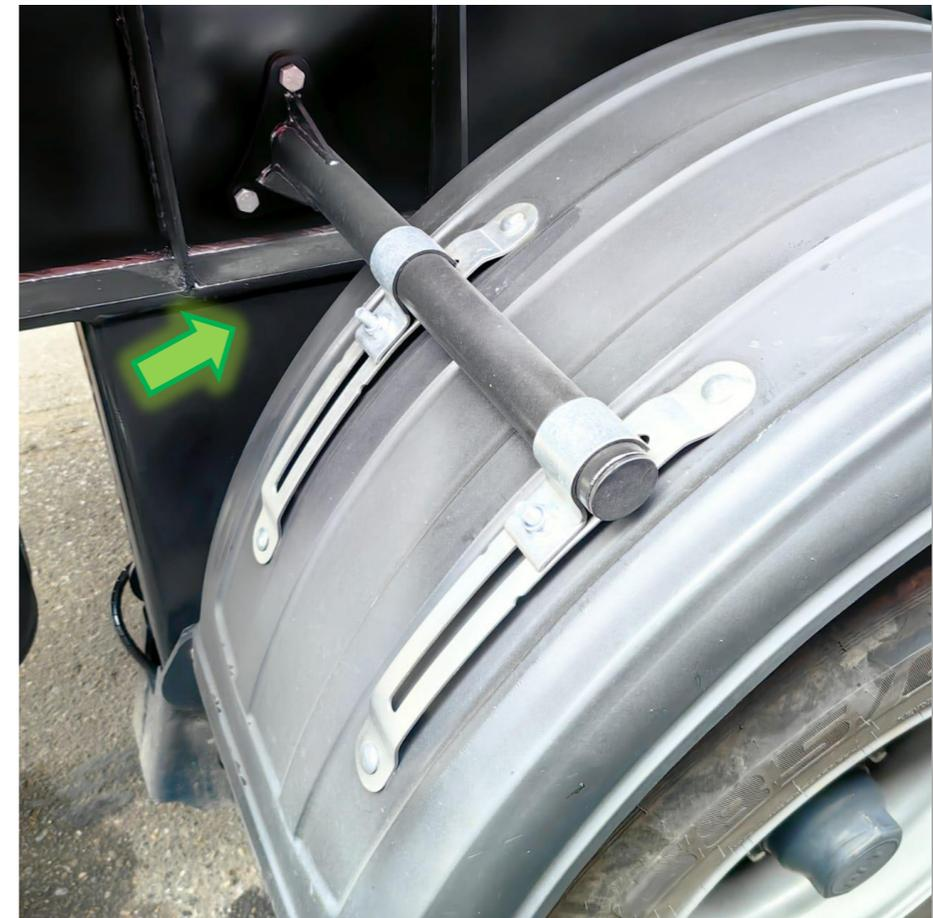
В конструкцию модернизированного полуприцепа-самосвала НЕФАЗ-9509 внедрены новые кронштейны крепления крыльев колёс, исключая скопление насыпного материала – широко доступны на рынке запасных частей, оперативная замена при поломке.
