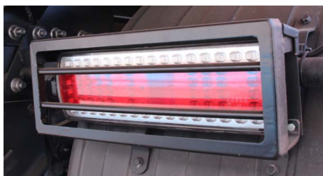
Световая и звуковая сигнализация о поднятом кузове.
