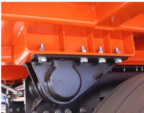
Надрамник – высокопрочная сталь DOMEX S420MC, швеллер 180x80x8 мм.
