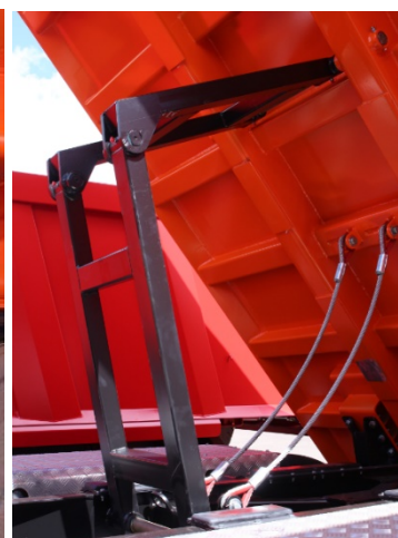
Надрамник – высокопрочная сталь DOMEX S420MC, швеллер 180x80x8 мм.
