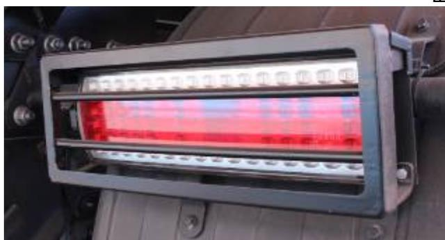
Световая и звуковая сигнализация о поднятом кузове.
