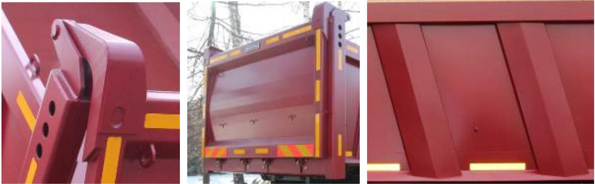
Задний борт имеет автоматический механизм блокировки и размыкания.
