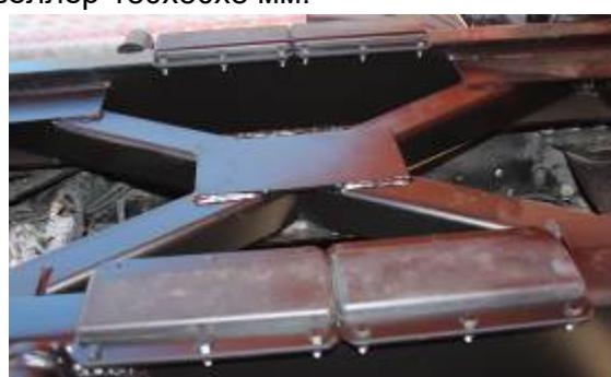
Боковая защита и крылья над задними колесами – входят в комплектацию шасси.
