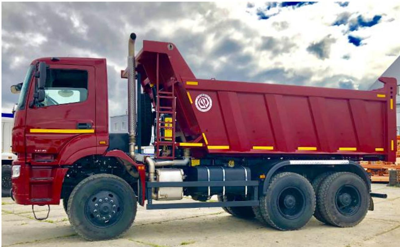
Износостойкая сталь, используемая в конструкции днища кузова, отличается высокой твердостью по Бринеллю, высоким пределом прочности на разрыв, повышенным сопротивлением вмятинам и стойкостью к абразивному истиранию, поэтому позволяет снизить массу конструкции и продлевает срок службы, обеспечивая снижение затрат на эксплуатацию самосвала в течение жизненного цикла.
