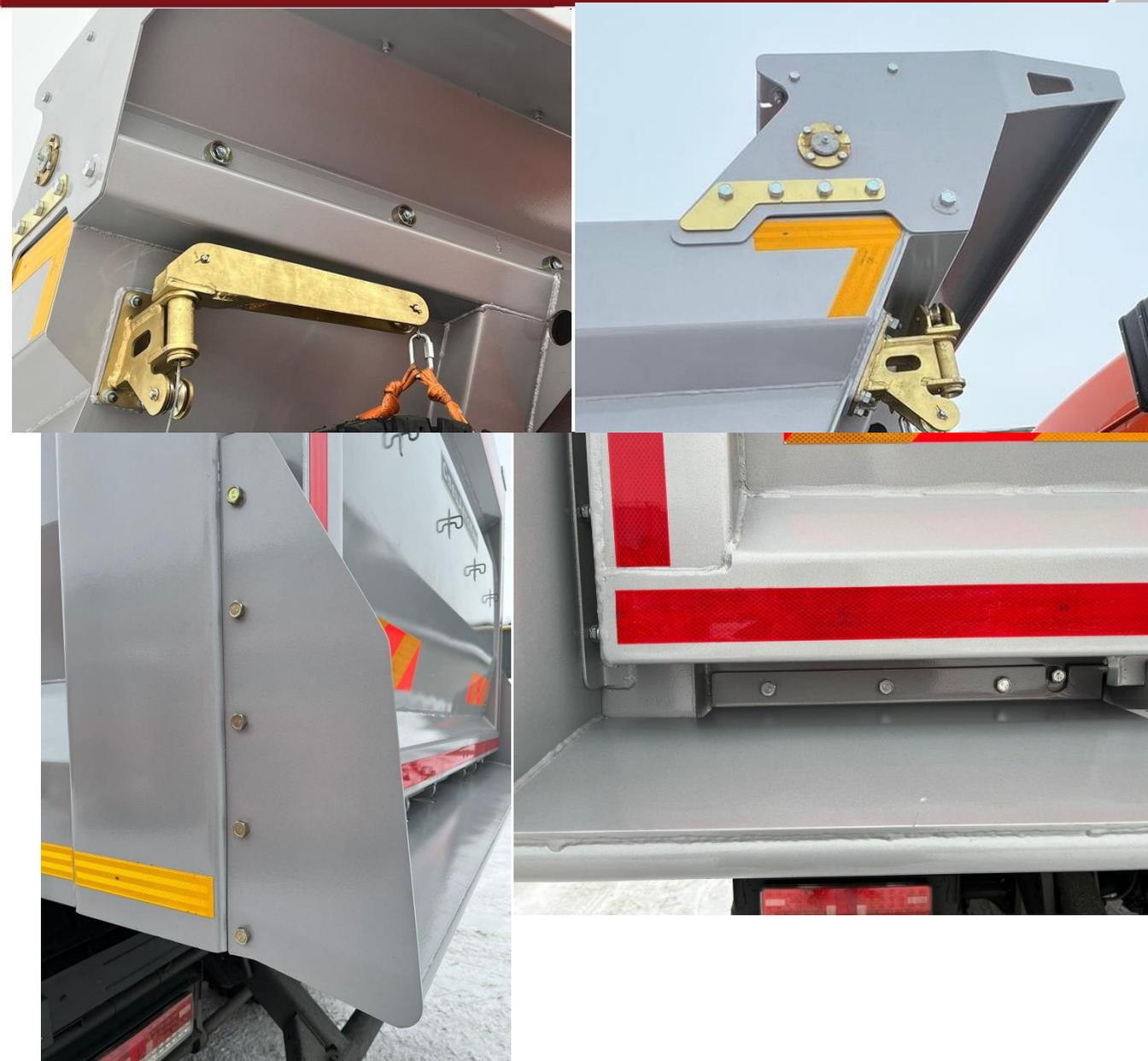
Козырёк над гидрооборудованием и задний лоток самосвальный платформы закреплены на платформе болтовыми соединениями. При необходимости элементы можно заменить без использования резки и сварки. На козырьке болты защищены от срыва и деформации в период эксплуатации специальными гальванированными шайбами, полностью защищающими крепление болтов от внешних воздействий.
