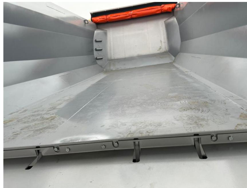
Объём самосвальной платформы 16м<sup>3</sup>, Грузоподъёмность автомобиля 6522KZ 19 325 кг.
