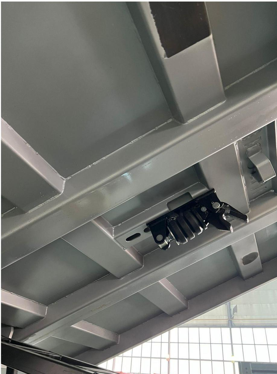
В связи с использованием автомобиля на дорогах с плохим или частично отсутствующим дорожным покрытием, на платформе установлена система блокировки кузова Bodyfix (HYFIX), исключающая опрокидывание кузова и повреждение шасси вызванных выбоинами и неровностями дороги.
