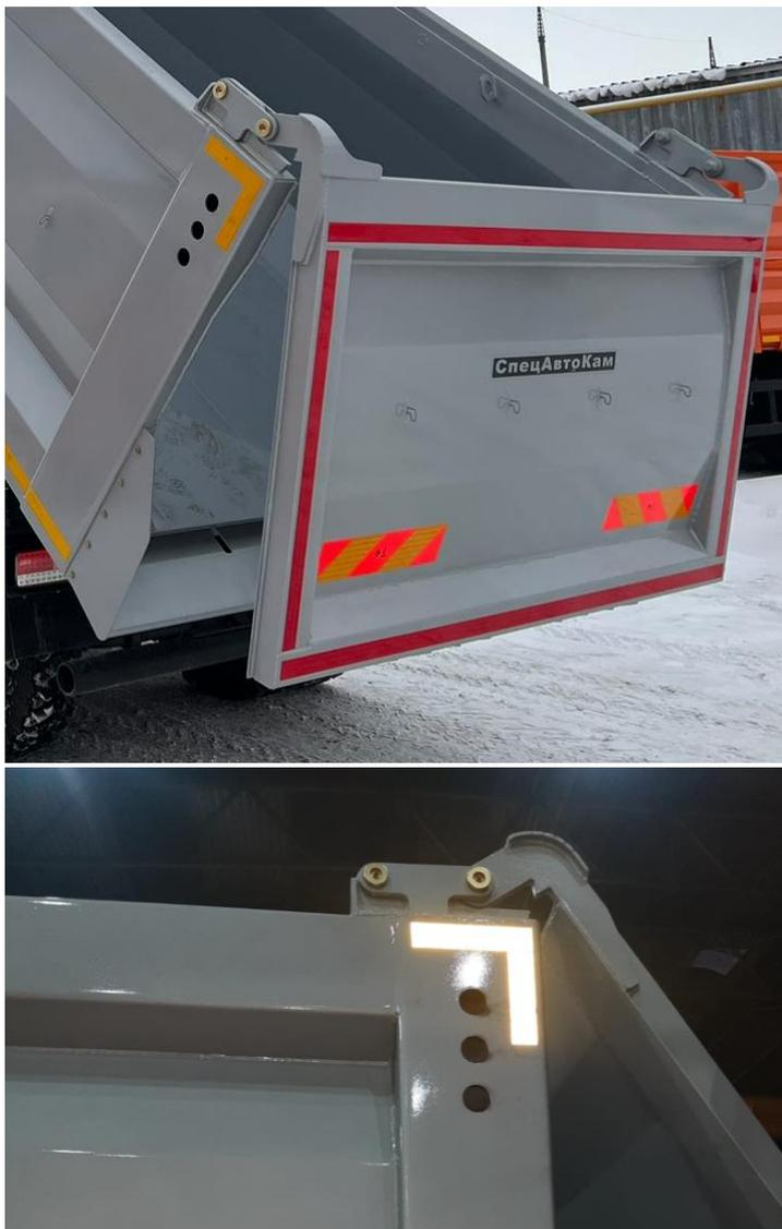
Задний навесной борт на двух-шарнирном исполнении – безопасность выполнения работ при разгрузке груза на приемочные лотки дорожной техники (асфальтаукладчик). Автомобили с обычными задними навесами бортов пересыпают асфальт в лоток асфальтаукладчика, в связи с чем выделяются дополнительные рабочие выполняющие 2 функции:
