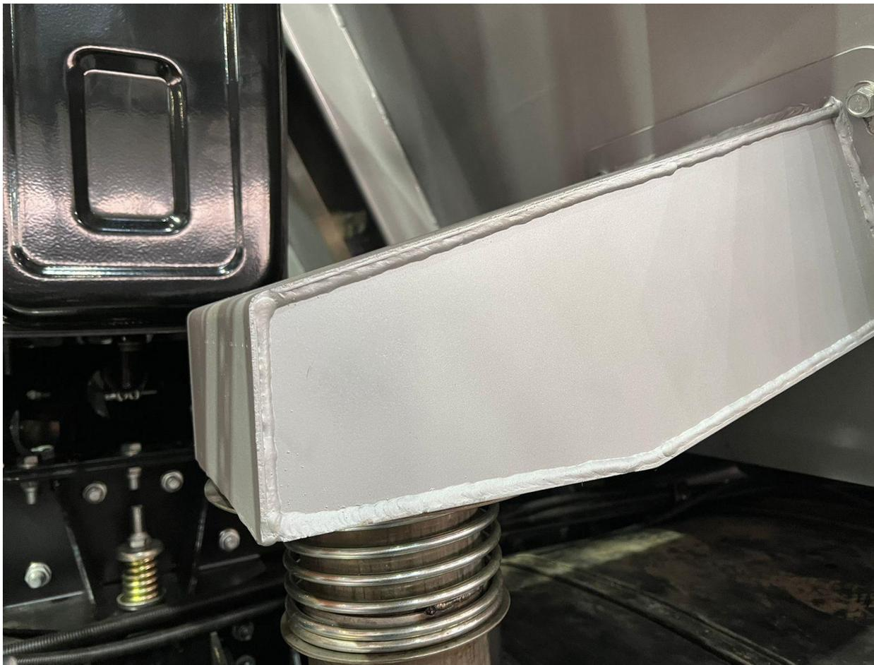
Конструктора ООО «СпецАвтоКам» разработали собственную интегрированную систему обогрева платформы выхлопным газом. Выхлоп распределяется по всему основанию платформы равномерно без турбулентности, с делителем на поток, значительно снижая намерзание грунта в сравнении с платформами данного класса грузоподъёмности от других производителей.
