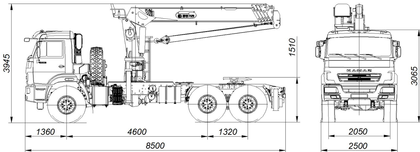
Размеры для автомобиля снаряженной массы: \* - с шинами 425/85R21
